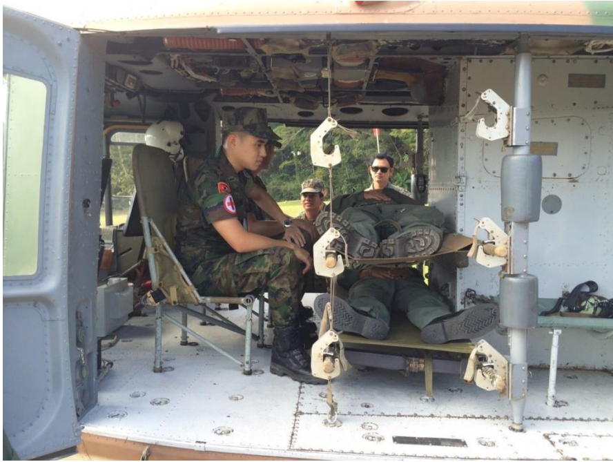
รูปที่ ๓ ตำแหน่งการวางเปลผู้บาดเจ็บ และการนั่งของเจ้าหน้าที่พยาบาล
