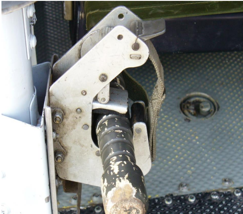
รูปที่ ๔ เปลต้องอยู่ในตำแหน่งล็อกให้เรียบร้อย
